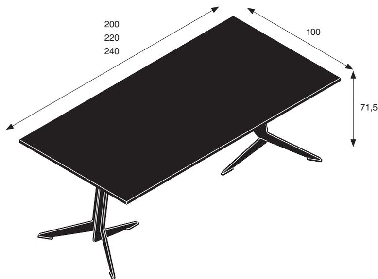
Das Tischgestell des TRI verkörpert die zeitgemäße Interpretation von Säulenfüßen mit Bodenausleger und besteht aus zwei Stahlblechen, die sich mittels Verschränkung gegenseitig stabilisieren. Für TRI werden ausschließlich wertige Materialien auf hohem Niveau verarbeitet. Er überzeugt durch sein innovatives Design und verleiht dem Raum Charakter.
