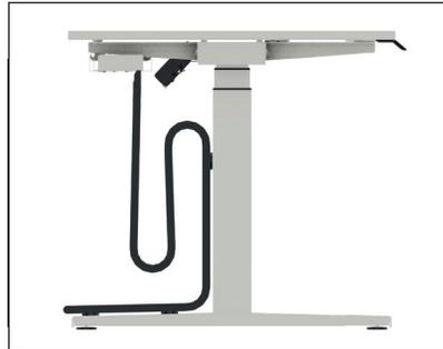
Vertikalkabelführung am Tischbein
