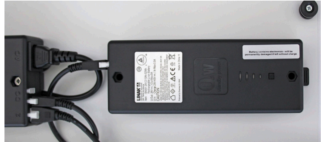
Der optionale Akku wird unter der Tischplatte einfach in die Halterung eingeklippt.
